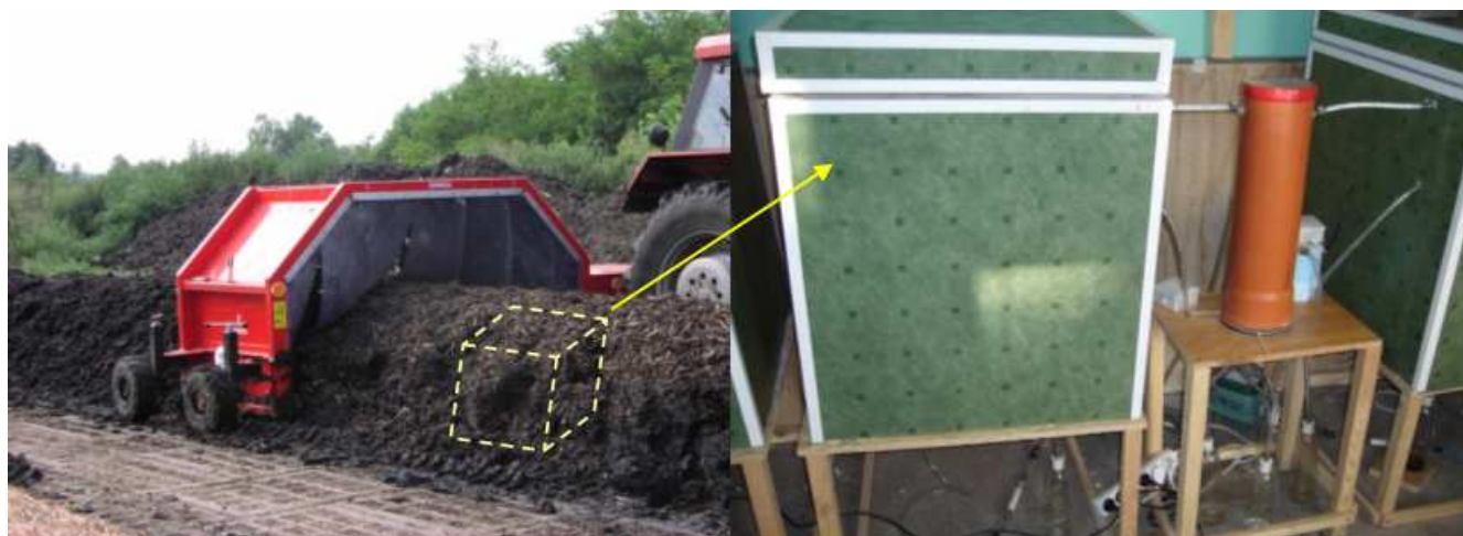
Rys. 3. Fragment przyzmy kompostowej odzwierciedlającej pojemność bioreaktora Fig. 3. A section of composting pile showing bioreactor capacity
