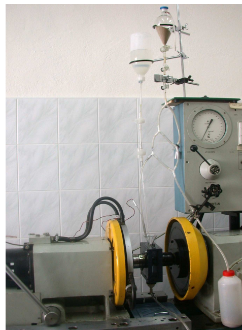
Rys. 6a. Fotografia układu dostarczającego medium
