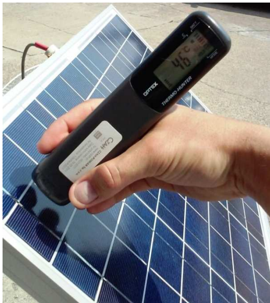
Fig. 1. A measurement of the PV module surface temperature Rys. 1. Pomiar temperatury powierzchni modułu PV
