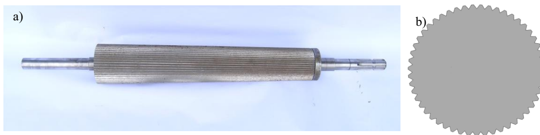
Fig. 1. Steel conical briquetting roller. a) view of the roller, b) cross section of the roller model Rys. 1. Stalowy stożkowy walec brykietujący. a) widok walca, b) przekrój modelu walca
