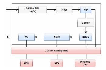
Fig. 9. SEMTECH DS operation schema [10] Rys. 9. Schemat działania mobilnego analizatora SEMTECH DS. [10]
