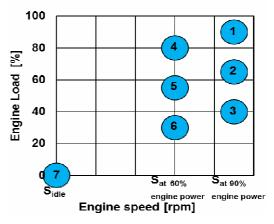
Fig. 7. The NRSC test points after modification [9] *Rys. 7. Schemat testu NRSC po modyfikacji* [9]
