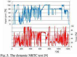
Rys. 5. Schemat testu NRTC [9]
