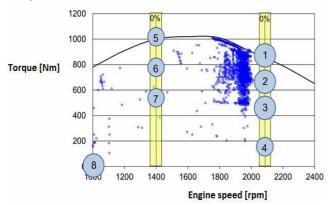
Fig. 6. Comparison of agricultural tractor engine operating range in real conditions with NRSC test points [9] *Rys.* 6. *Porównanie zakresu pracy ciągnika rolniczego*
