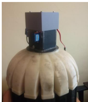
Fig. 4. Seed distribution uniformity collector prototype mounted on the drill head Rys. 4. Prototyp ulepszonoego kolektora równomierności rozdziału nasion zamontowany na głowicy rozdzielczej
