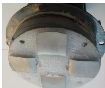
Fig. 5. Sensors: a) piezo-ceramic b) piezoelectric film, mounted on the distribution collector Rys. 5. Zamontowane na korektorze rozdziału czujniki: a) piezo-ceramiczne b) folia piezoelektryczna
