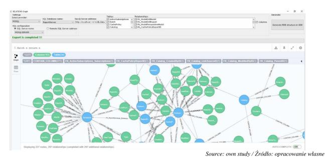
Fig. 5. The application interface with results of querying the graph base representing a given relational structure *Rys. 5. Interfejs aplikacji z wynikami odpytywania bazy grafowej, reprezentującej wybraną strukturę relacyjną*
