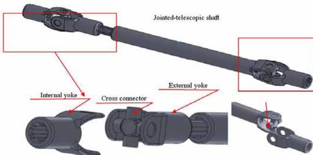
Fig. 4. Solid model of jointed-telescopic Power Take-Off shaft with Cardan joint Rys. 4. Model brylowy wałka przegubowo-teleskopowego z przegubem Cardana
