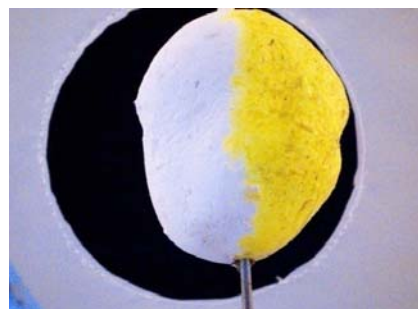
Rys. 5. Ziemniak pomalowany białą farbą emulsyjną, opryskany kontrastem z klimatyzacji samochodowej, zdjęcie w świetle halogenowym Fig. 5. Potatoes painted with white emulsion-color, sprayed with car air conditioning contrast, the picture in the halogen light
