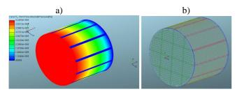
Fig. 6. a) the result of simulation of the absolute flow pressure, b) filter mesh prepared for simulation [7] *Rys. 6. a) wynik symulacji absolutnego ciśnienia przepływu, b) siatka filtra przygotowanego do symulacji [7]*
