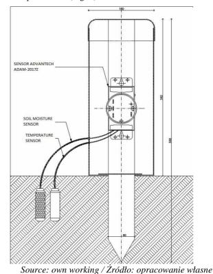
Fig. 3. Design of the measuring element *Rys. 3. Projekt elementu pomiarowego*
